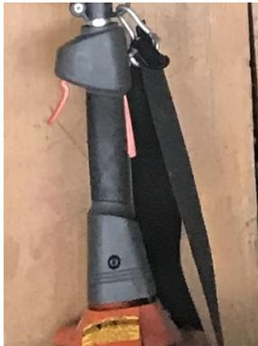
*Teleskop-Kettensäge Abbildung 8-2 (Gashebelsperre mit Start / Stop Schalter*
